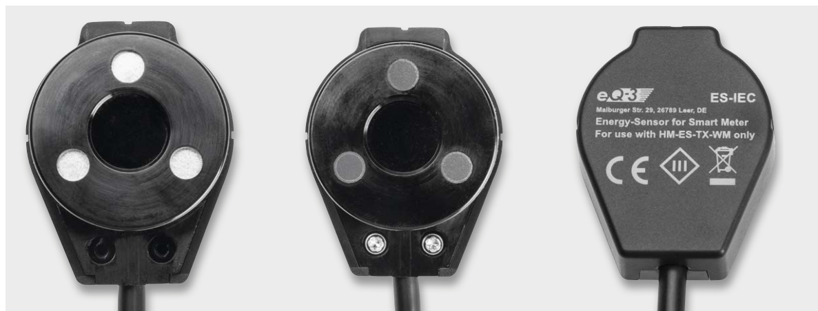
Bild 12: Nachdem man sich vergewissert hat, dass die Anschlussleitung weit genug ins Gehäuse eingeschoben wurde, wird dieses mit den beiden TORX-Schrauben verschlossen und es sind die drei Klebefüße aufzukleben. Rechts das Gehäuse von der Unterseite gesehen.
