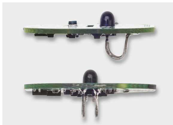
Bild 8: Der Einbau des Fototransistors muss in genau senkrechter Lage zur Platine erfolgen.
