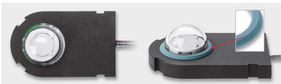
Bild 10: Die hier bereits vergossene Platine samt Sensor. Hier ist noch der Dichttring mit der abgeschrägten Seite nach oben aufzusetzen.
