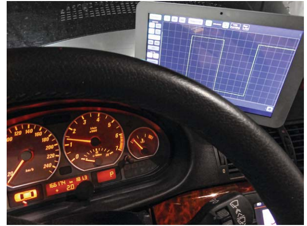
Bild 1: Sehr mobil dank WLAN-Verbindung zum Tablet-PC, hier wird das Verhalten eines Kurbelwellensensors im Betrieb erfasst.
