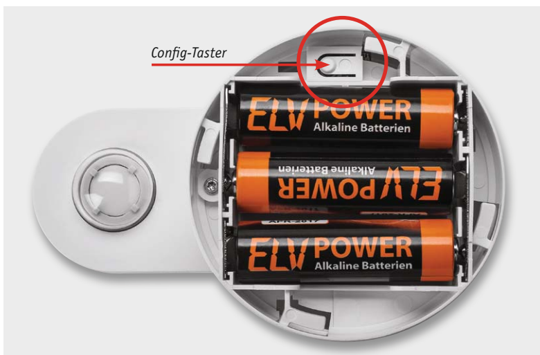
Bild 22: Nach dem Einlegen der Batterien wird die Halterung in das Batteriefach eingerastet ...
