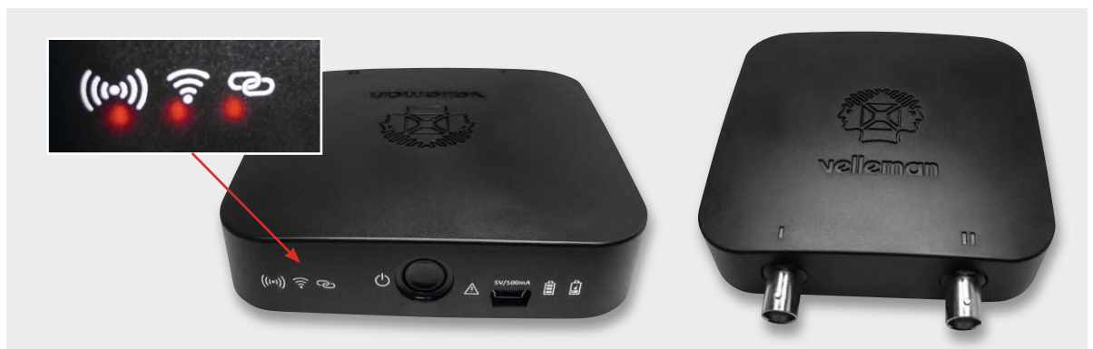
Bild 2: Die Bedien-, Anzeige- und Anschlusselemente des WFS210 im Überblick
