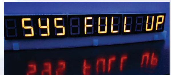
Bild 5: Darstellung von Informationstexten mit 7-Segment-Anzeigen
